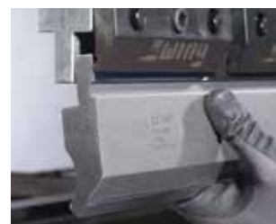
Вертикальный демонтаж пуансона/верхнего инструмента
