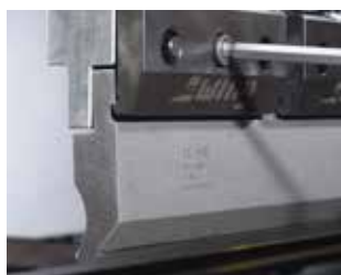
Ослабьте болты, пуансон/ верхний инструмент защищён от выпадения
