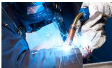
Наплавка металла на повреждённый инструмент (MAG-сварка)
