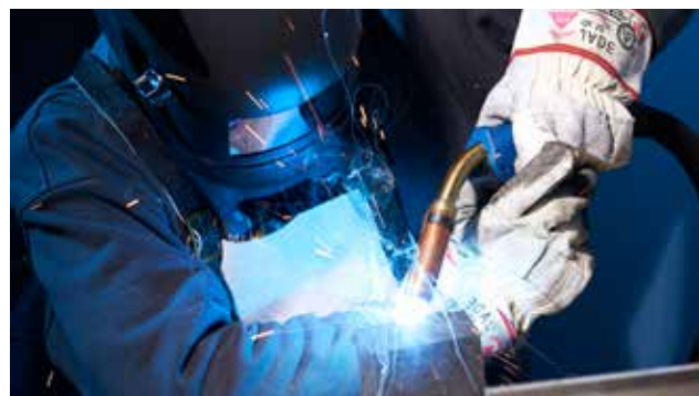
Наплавка металла на повреждённый инструмент (MAG-сварка)
