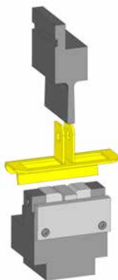
У-образный инструмент с малыми внутренними размерами и вырезом длягиба 90°
